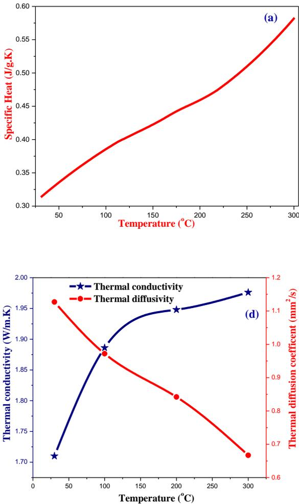
Fig. 3 (c) specific heat and (d) thermal diffusion coefficient and thermal conductivity of CdGa<sub>2</sub>Se<sub>4</sub>.
